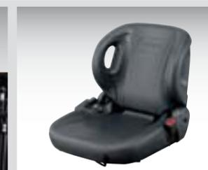
El asiento de retención del operador (ORS), el cual utiliza tecnología patentada por Toyota, se ofrece de manera opcional. Este asiento se instala cuando se ha seleccionado el sistema de Sensor de Presencia de Operador (OPS).
