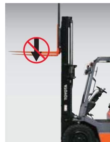
Una vez apagado las horquillas no descienden aunque se operen las palancas de manejo de carga. Esta función puede ayudar a prevenir accidentes causados por una operación involuntaria llevada a cabo por otra persona ajena al operador.
