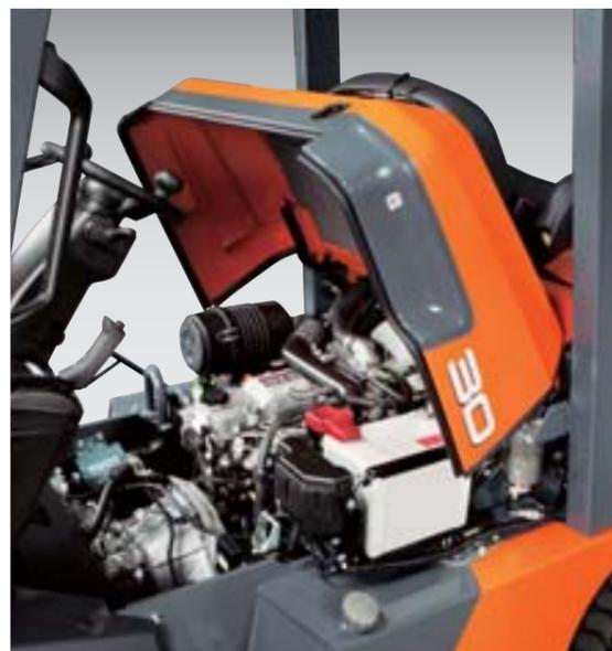
La cubierta de motor de amplia apertura permite un fácil acceso al motor durante una inspección o servicio.
