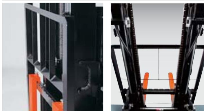
El mástil en la posición de reposo inferior asegura una buena visibilidad del extremo de las horquillas, lo cual facilita su inserción dentro de los pallets cuando se encuentran en el piso.
