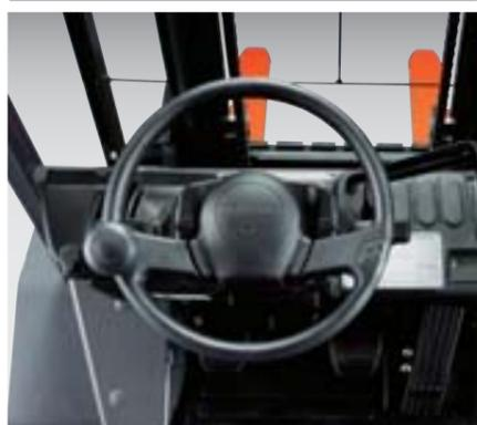
El volante de diámetro pequeño se une al sistema de dirección completamente hidráulico para proporcionar una excelente maniobrabilidad. La columna de dirección ofrece un ajuste continuo que se adapta a un amplio rango de preferencias del operador.
