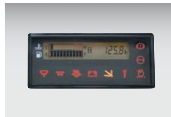
Este medidor combinado incluye el indicador de temperatura de agua, medidor de combustible, contador de horas, alarma de temperatura de aceite del motor y otros indicadores, lo cual facilita la verificación del estado del montacargas.
