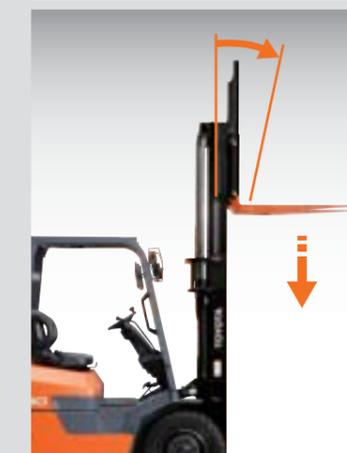
Una válvula de verificación en la válvula de control reduce la posibilidad de descenso espontáneo de las horquillas y la inclinación hacia delante. Esta función se instala cuando se ha seleccionado el sistema OPS.
